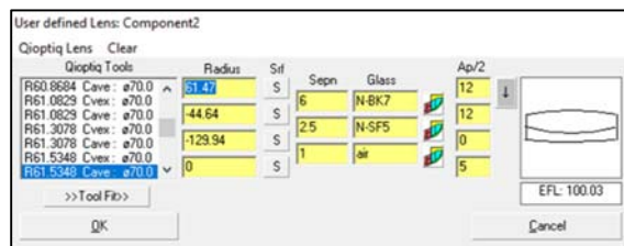
Figure 5b. Lens 2 Parameters
